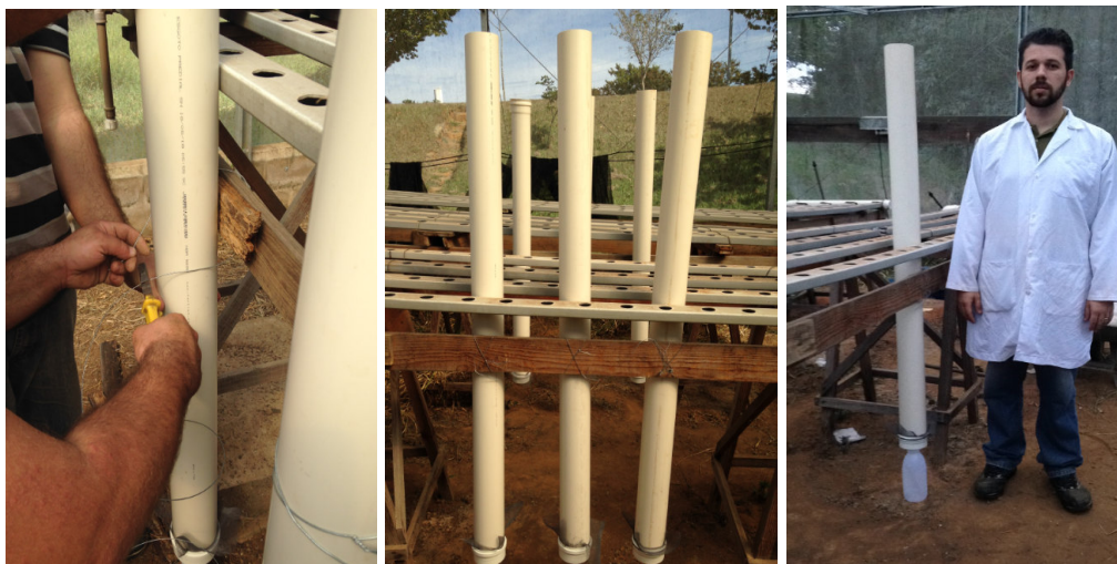
FIGURA 1 - Simuladores utilizados para coletar água percolada pelo rejeito e solo natural.
