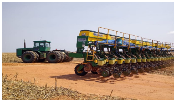
FIGURA 2. Trator agrícola Engesa, modelo 1124 e semeadora da marca tatu, modelo USAP, 36 linhas, utilizada no estudo.
