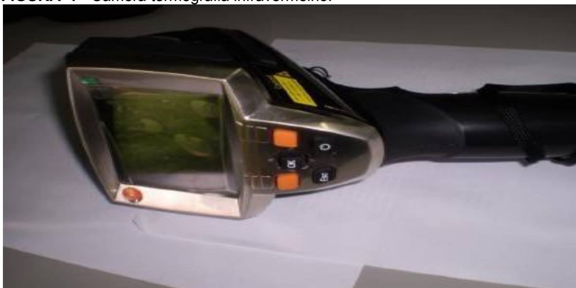
FIGURA 1- Câmera termografia infravermelho.
