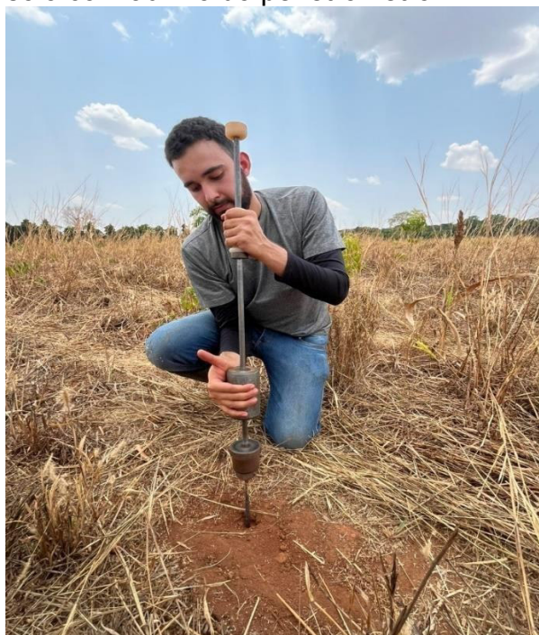
FIGURA 4. Avaliação de compactação do solo com auxílio do penetrômetro.
