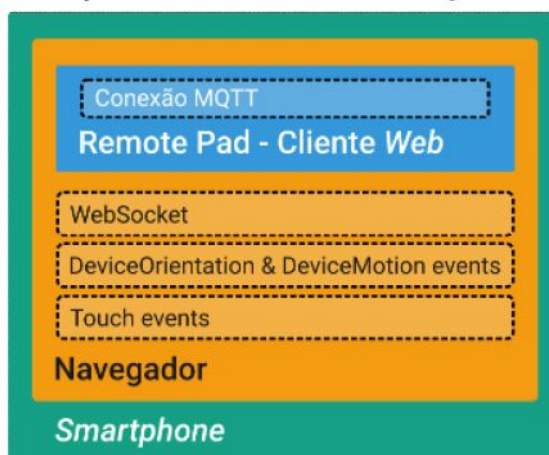
FIGURA 4 - Conjunto de camadas de execução do cliente web.
