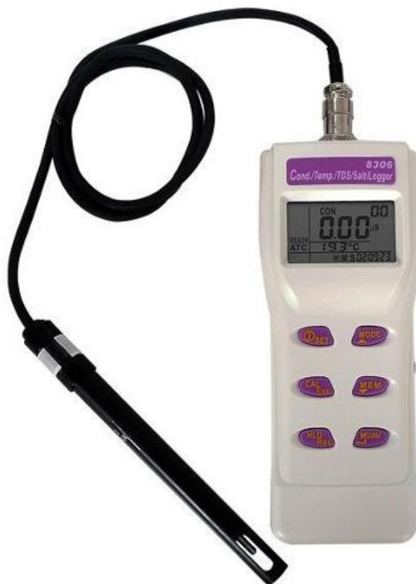
**FIGURA 4** – Modelo de aparelho portátil para medição da CE do leite.
