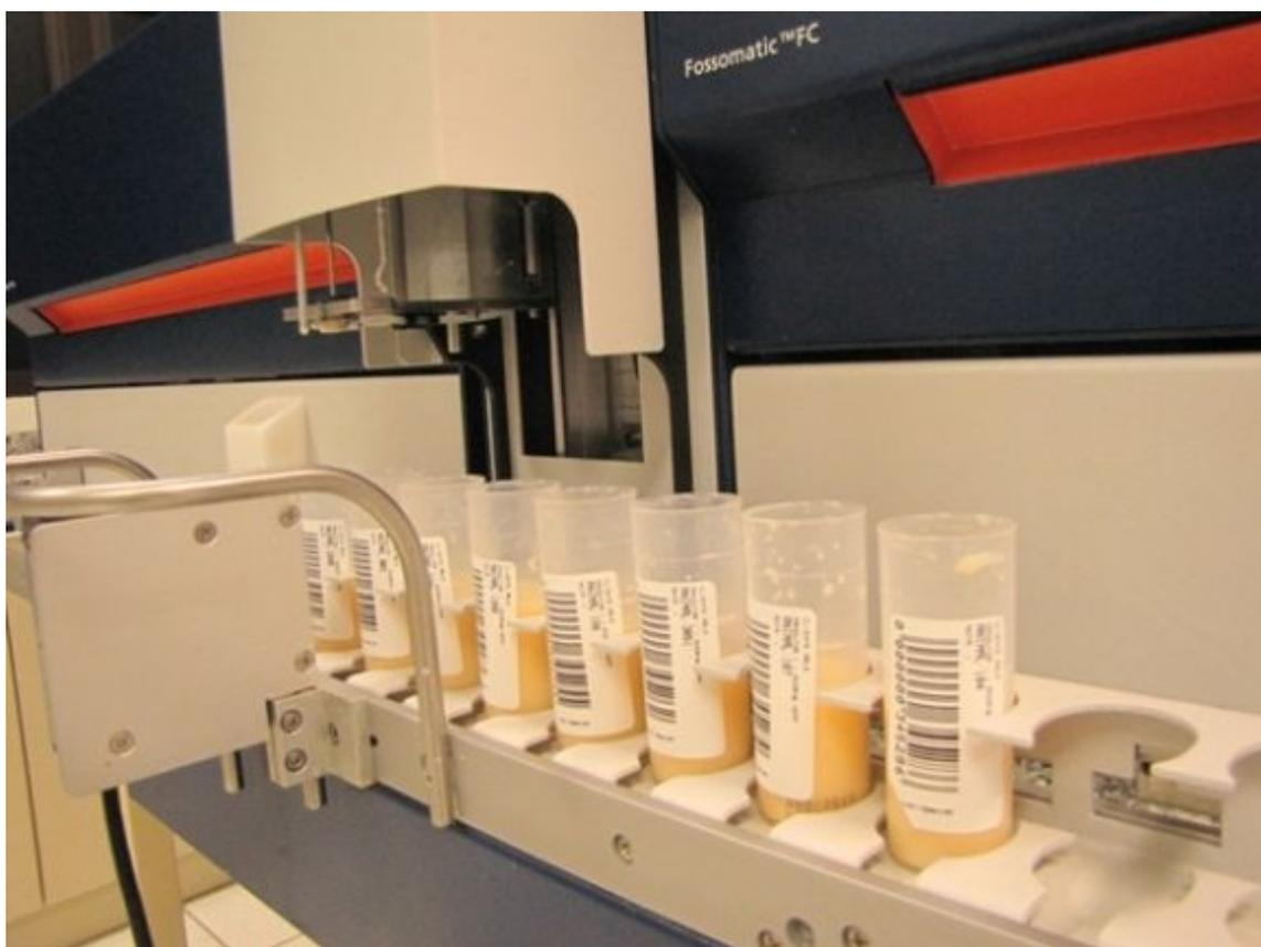
**FIGURA 3** – Equipamento eletrônico Fossomatic para contagem de células somáticas através da citometria de fluxo. Fonte: CRUZ et al., (2018).
