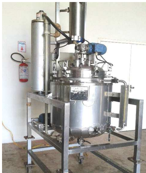
FIGURA 4 – Reator de processo encamisado de 50L. Fonte: Autores
