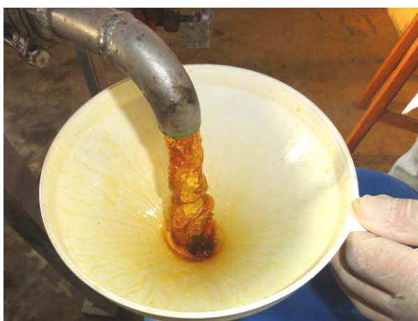
FIGURA 6 – Recolhimento da fração oleosa (diesel vegetal). Fonte: Autores
