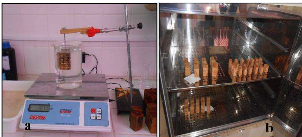
FIGURA 3. Determinação da densidade básica: a) obtenção do volume pelo método do deslocamento de água; b) secagem das amostras em estufa. Fonte: Próprio autor.
