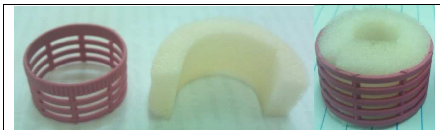
FIGURA 2. Materiais utilizados como meio suporte para o BFAS. Fonte: A autoria própria
