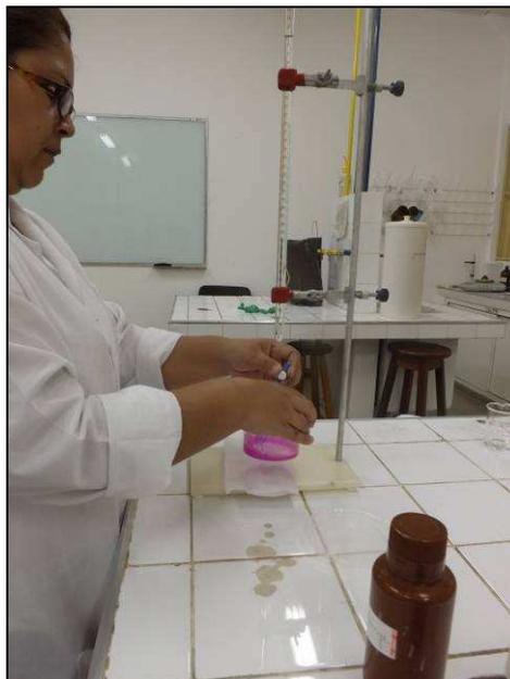
**FIGURA 3.** Quantificação do CO<sub>2</sub> captado do solo por titulação.
