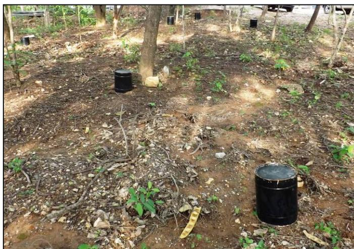
**FIGURA 2.** Campânulas na área de coleta de efluxo de  $\text{CO}_2$  do solo. (Fonte: autores)
