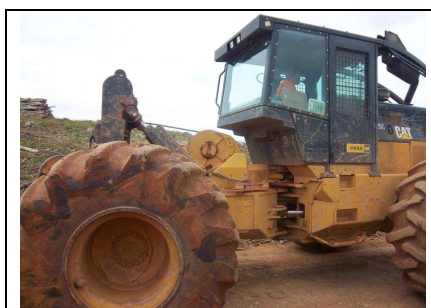
FIGURA 2. Skidder Caterpillar modelo 545C Fonte: autores
