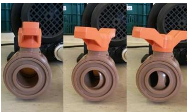
FIGURA 6 – Registro completamente aberto, 70 e 40% aberto, respectivamente. Fonte: Os autores.
