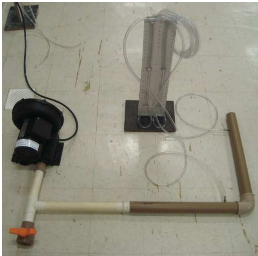
FIGURA 7 – Instalação para a tubulação mais grossa. Fonte: Os autores.
