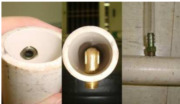
FIGURA 2 – Encaixes simples (medição da diferença de pressão), tipo cotovelo para o Tubo de Pitot e imagem de como é feita a conexão da mangueira do tubo em U.
