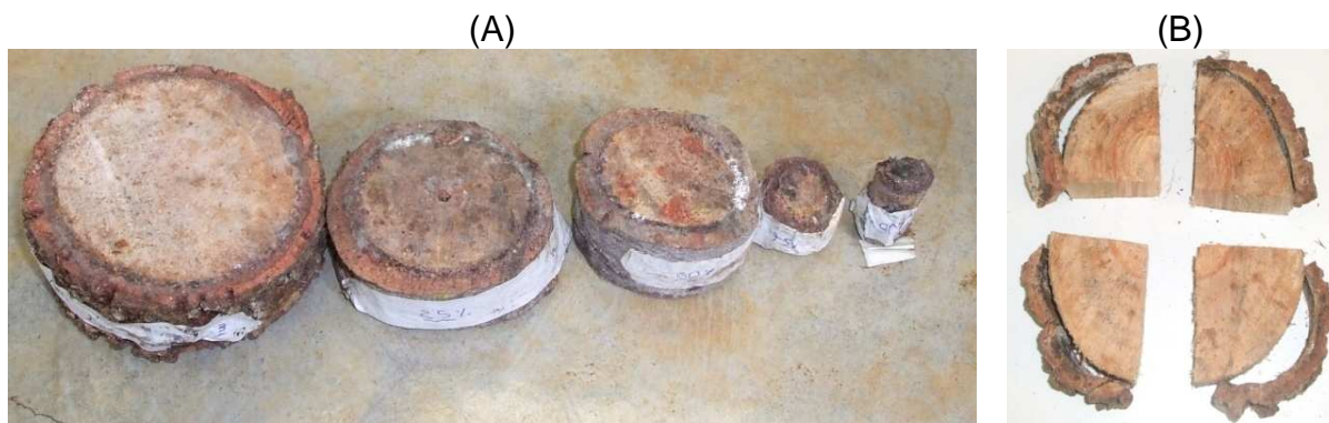
FIGURA 1: Discos e cunhas retirados das árvores de barbatimão ( Stryphnodendron adstringens (Mart.) Coville) para a determinação da densidade básica: (A): Discos retirados; (B): Disco seccionado. Fonte: GAMA, 2012.
