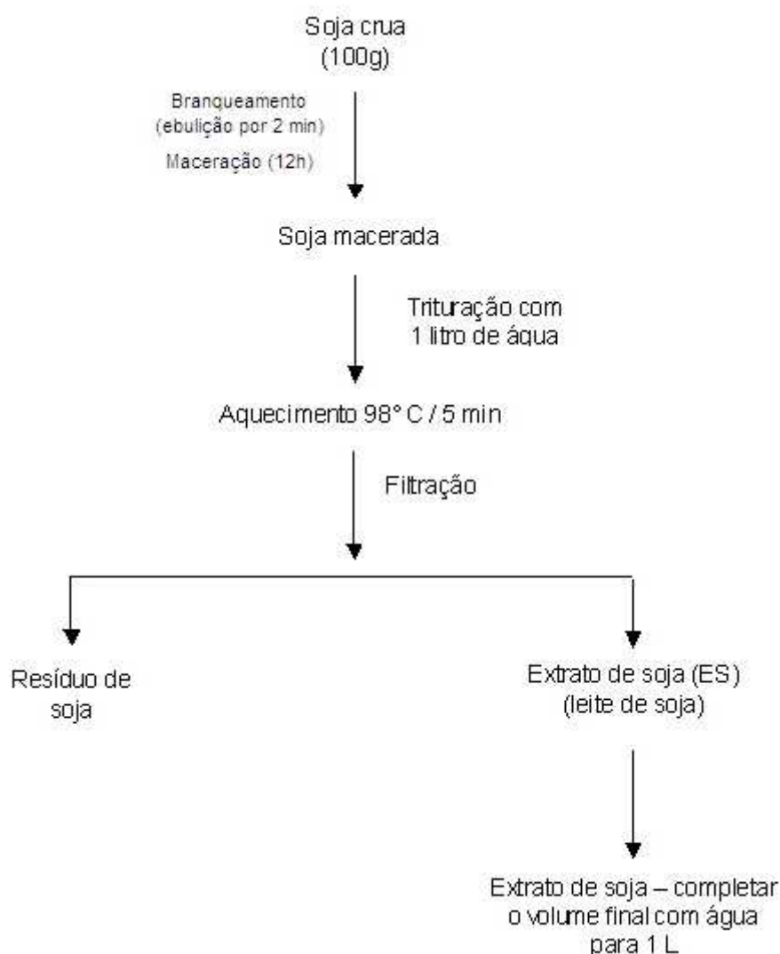
FIGURA 1 - Fluxograma de obtenção do extrato de soja utilizado na obtenção do produto proposto, conforme CIABOTTI (2004).
