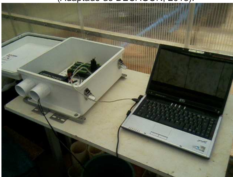
FIGURA 3. Data logger instalado junto a um computador para a medição diária de condutividade.
