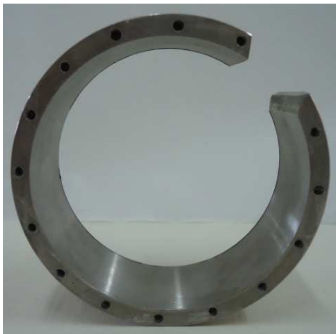
FIGURA 7: Carcaça de aço inoxidável com os devidos furos de fixação.
