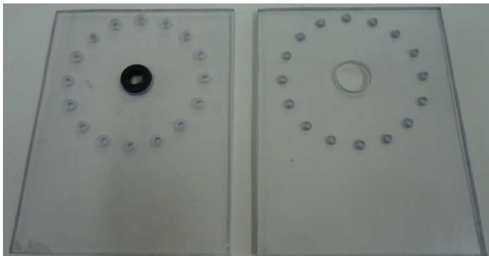
FIGURA 5: Tampas laterais com os devidos furos e com o retentor acoplado. Fonte: Os autores
