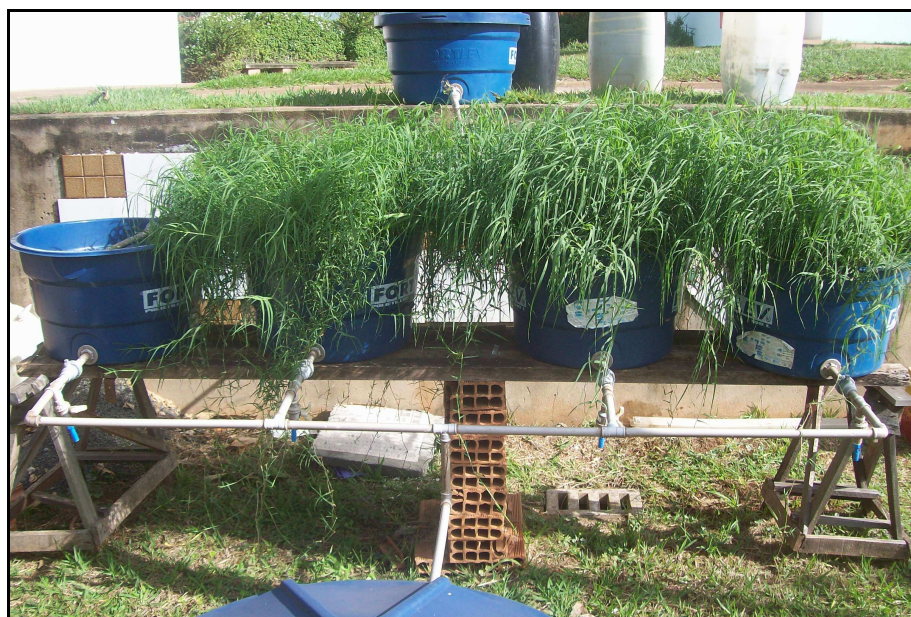
FIGURA 2. Leitos cultivados instalados na Universidade de Uberaba para o pós-tratamento de efluente de suinocultura ao final do experimento
