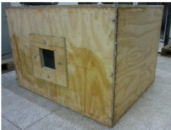
Figura 3 – Caixa reverberante para utilização nos testes acústicos
