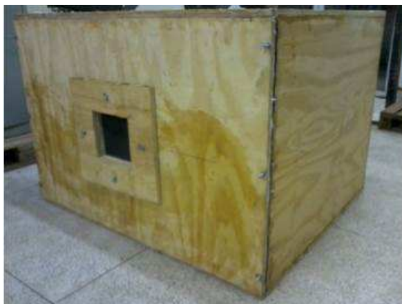
FIGURA 7 - Caixa de reverberação confeccionada para testes acústicos
