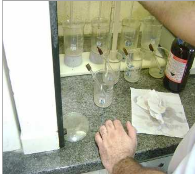
FIGURA 4 - Adição de NaOH na solução com papel macerado. Fonte: Acervo do autor.
