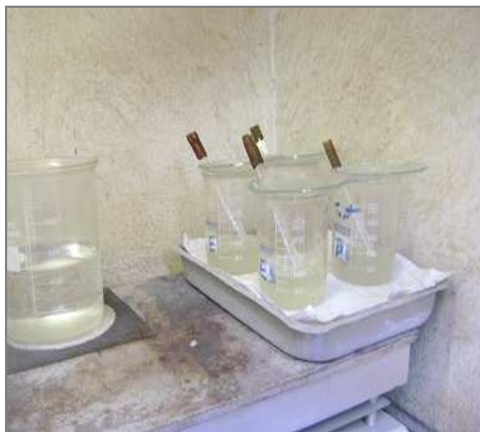
FIGURA 3 - Solução na placa aquecedora para determinação do resíduo insolúvel.
