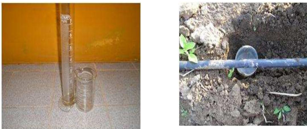
**FIGURA 1.** Equipamentos usados na determinação da vazão do emissor.
