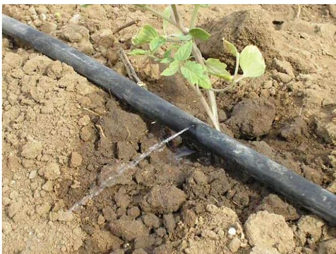
**FIGURA 2 .** Linha de gotejador furada, com desperdício de água
