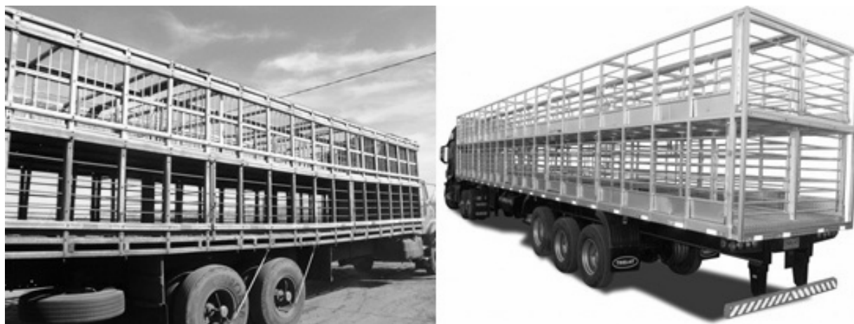
FIGURA 3: Exemplo de caminhão truck com piso de madeira (esquerda) e carreta de carroceria metálica
