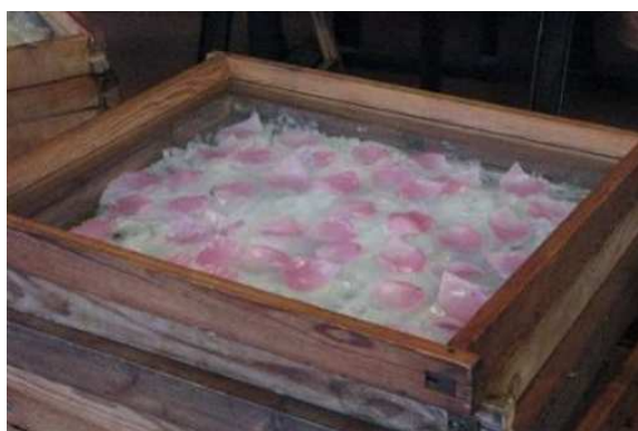
FIGURA 6 - Processo de extração de óleo essencial por enfleurage (NEVES, 2011).
