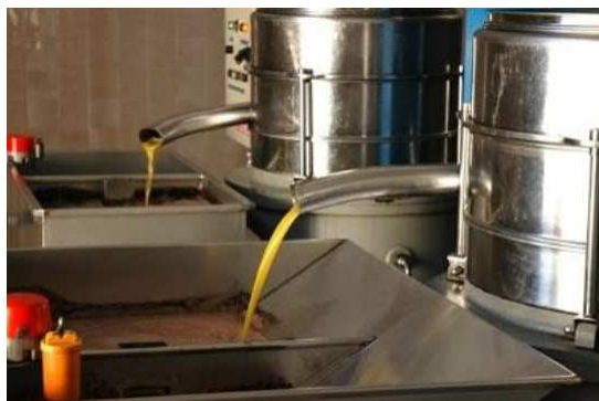
FIGURA 7 - Processo de extração de óleo essencial por prensagem a frio (NEVES, 2011).
