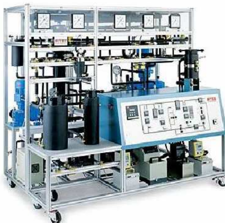
FIGURA 5 - Planta de extração de óleo essencial por fluido supercrítico (PATEL et al. , 2011).
