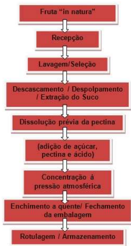
FIGURA 1. Fluxograma básico de processamento da geleia de acerola com goiaba, Cruz das Almas-Ba, 2010.
