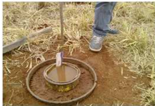
Figura 4. Régua de leitura inserida no anel. Fonte: Os autores.
