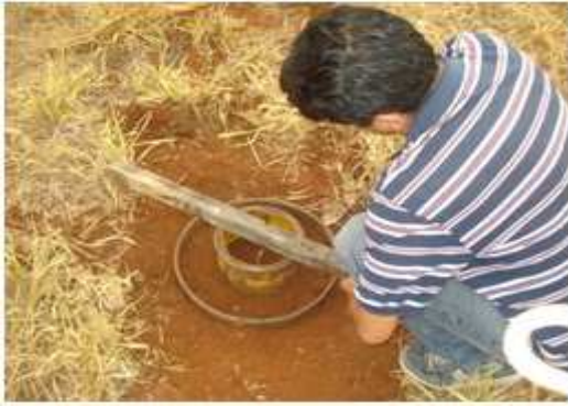
Figura 1. Instalação do infiltrômetro de anel. Fonte: Os autores.
