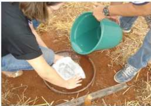
Figura 3. Acréscimo de água no anel. Fonte: Os autores.
