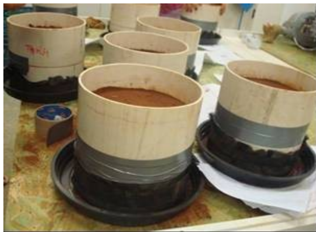
FIGURA 3- Vasos com a camada de solo de 10 cm inferior preenchido na densidade de 1,0 \text{ Mg m}^{-3} e camada de solo compactada de 5 cm no anel superior.
