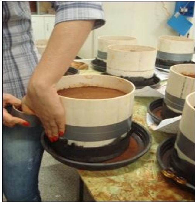
FIGURA 2- Montagem dos dois anéis de PVC 10 cm com o auxílio de fita adesiva “silver tape”.
