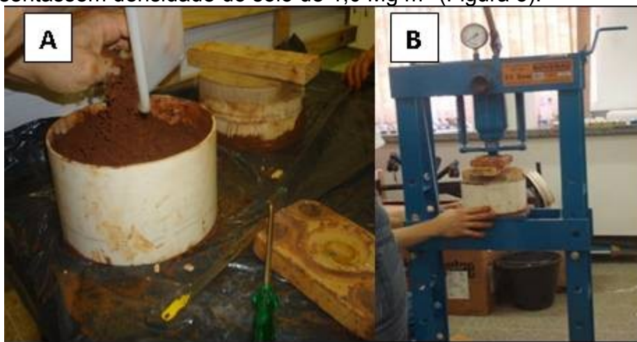
FIGURA 1- Preenchimento dos anéis PVC (A) e compactações do solo com o auxílio de uma prensa hidráulica Charlott PH5T (B).
