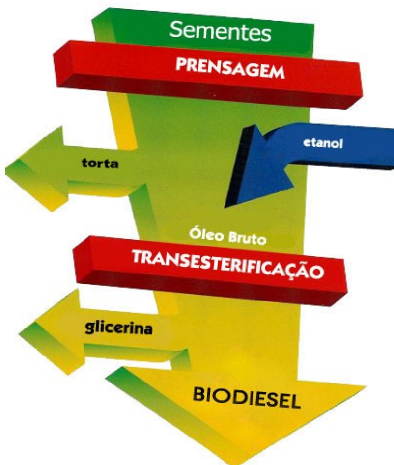
FIGURA 4. Esquema da produção do Biodiesel pelo processo de transesterificação. (Fonte: BIODIESELBR).
