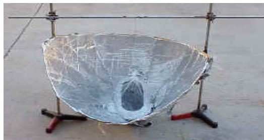
Figura 3.9. Fogão solar construído no Laboratório de Máquinas Hidráulicas e Energia Solar (LMHES).
