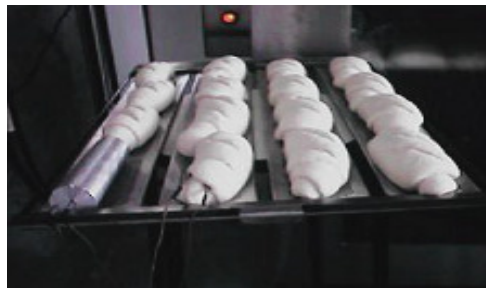
FIGURA 3.11. Foto da bandeja com o cilindro de alumínio e os pães com os termopares inseridos.
