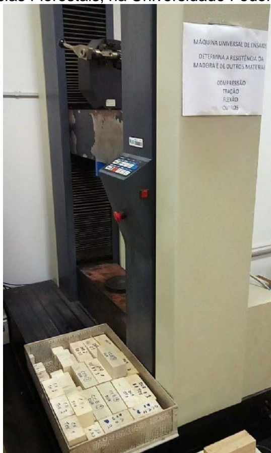
FIGURA 2. Prensa utilizada para realização dos ensaios de dureza Janka.
