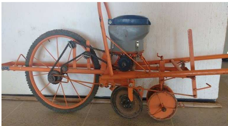
FIGURA 1. Semeadora manual Knapik, com sistema de distribuição de sementes por discos horizontais, UFCA, Crato, 2017.
